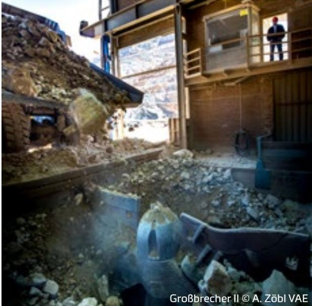
Im Großbrecher II werden die großen Gesteinsbrocken auf 15 cm zerkleinert. Danach kommt das Gestein auf ein Förderband und wird mit einem Gerät auf seinen Eisengehalt untersucht.
